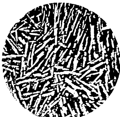
Fig. 2. Bronze mit 21.6% Blei unelektrol.
