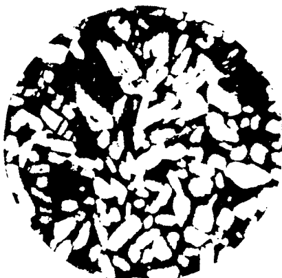
Fig. 6. Anodenteil einer mit 6 Amp./cm 2 elektrolysierten Bronze mit ursprünglich 21.6% Pb.
